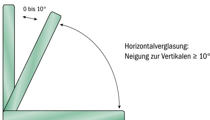
Abb. 4: Definition von Horizontalverglasung nach DIN 18008
